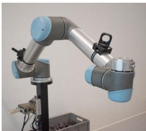
Abb 2: Roboterposition zum Montieren der Tool Unit.
