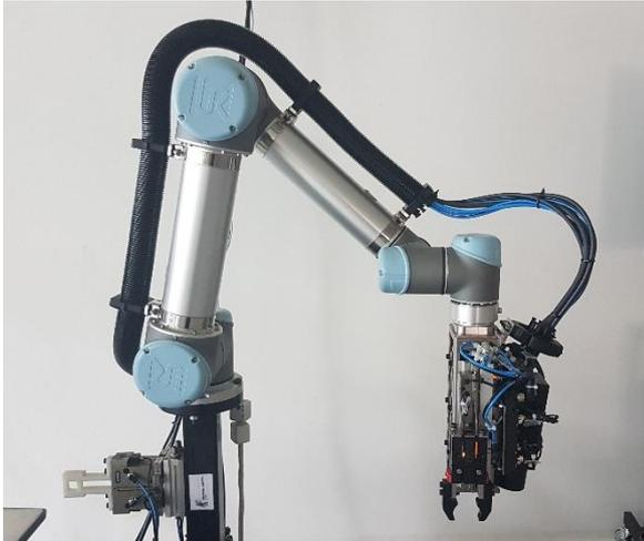
Abb 3: Energiekette auf dem Roboter montiert
